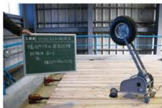
床衝撃音遮断性能試験
